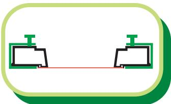
✓ Profilo con **basi** di appoggio e di tenuta **parallele**: permette una messa in opera rapida e precisa senza movimenti e distorsioni dovuti al serraggio.
