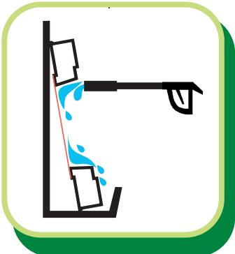
✓ Profilo con lato interno **inclinato**: non trattiene solvente/acqua in fase di sviluppo, recupero, lavaggio del telaio.
